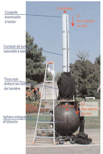
Figure 11 : Installation de mesure
